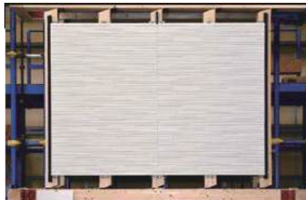
層間変位試験(社内試験)の様子
