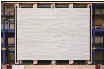
層間変位試験(社内試験)の様子
